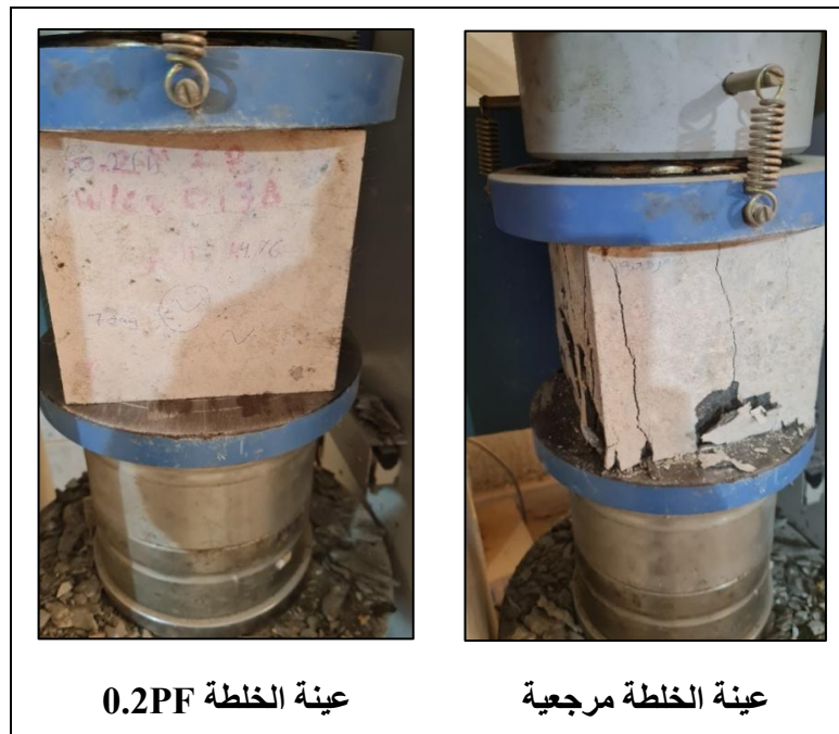
الشكل (1): شكل الانهيار لبعض عينات خلطات الالياف: الخلطة المرجعية والخلطة 0.2PF.
