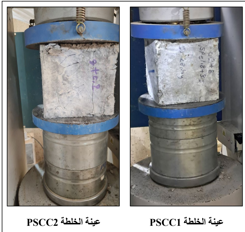
الشكل 4: شكل الانهيار لبعض عينات الخلطات ذات الاستبدال الثاني في الضغط.
