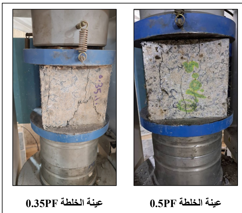
الشكل (2): شكل الانهيار لبعض عينات خلطات الالياف: الخلطة 0.35PF والخلطة 0.5PF.
