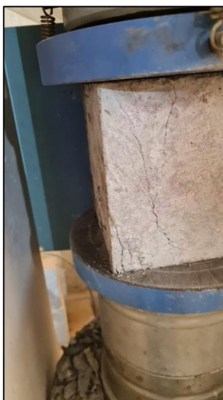
الشكل 3: شكل الانهيار لعينة الخلطة .S.SCC
